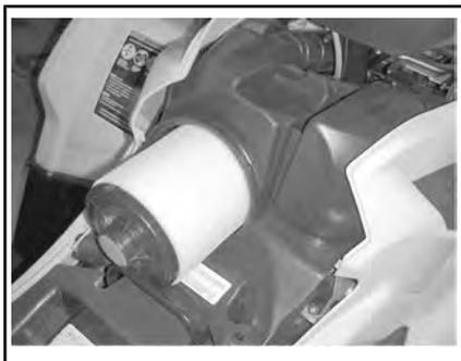
**RIMOZIONE DEL FILTRO DELL'ARIA**
