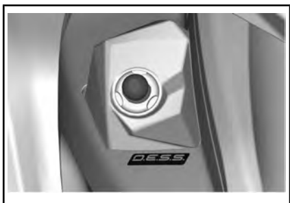
BORNE D.E.S.S. DU MOTEUR BORNE
