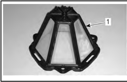
1. Filtre à air de la boîte de vitesses CVT
