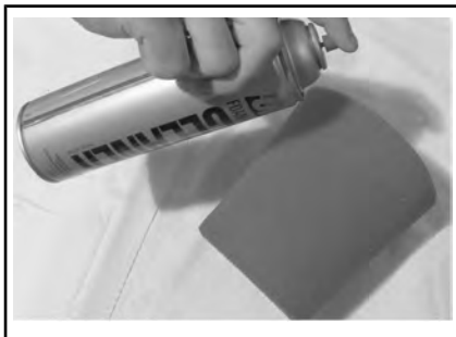
TYPIQUE - VAPORISEZ LE FILTRE EN MOUSSE
