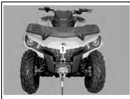
1. Emplacement du point d'arrimage avant
