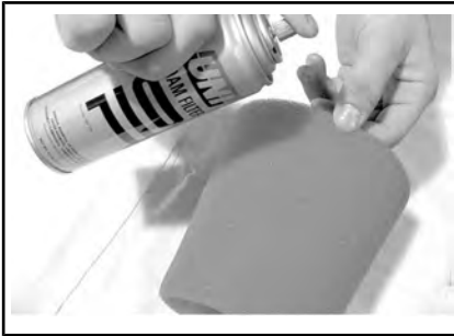
TYPIQUE - HUILEZ L'ÉLÉMENT DU FILTRE EN MOUSSE
