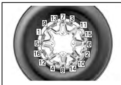
ТИПОВОЙ ВАРИАНТ - ПОРЯДОК ЗАТЯЖКИ ВИНТОВ
