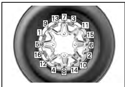
ТИПОВОЙ ВАРИАНТ - ПОРЯДОК ЗАТЯЖКИ ВИНТОВ
