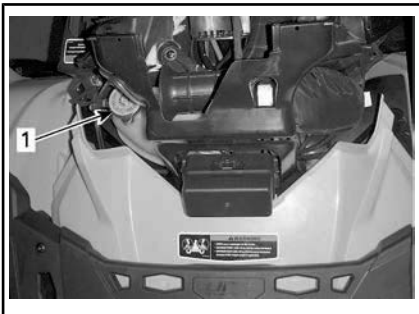
1. Tappo del serbatoio liquido refrigerante motore
