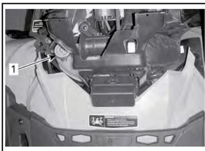
1. Réservoir du liquide de refroidissement
