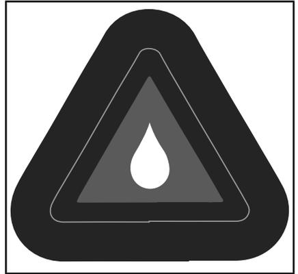
*НА БАЧКАХ ТОРМОЗНОЙ ЖИДКОСТИ*
