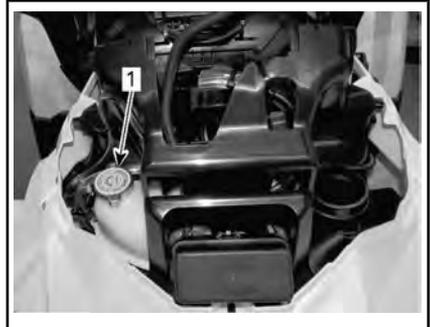
1. Крышка расширительного бака системы охлаждения двигателя
