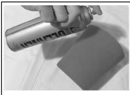
ТИПОВОЙ ВАРИАНТ – НАНЕСЕНИЕ МАСЛА НА ПОРОЛОНОВЫЙ ФИЛЬТР
