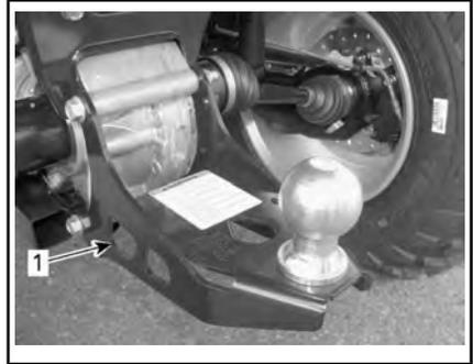
ТИПИЧНЫЙ ВАРИАНТ - РАСПОЛОЖЕНИЕ ЗАДНЕЙ ТОЧКИ КРЕПЛЕНИЯ
