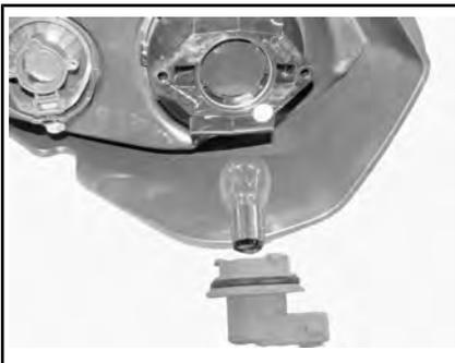
4. Отсоединить электрический разъем лампы от заднего фонаря.
