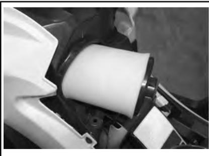
**СНЯТИЕ ВОЗДУШНОГО ФИЛЬТРА**
