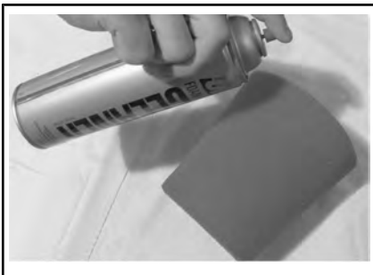
TYPISCH - SPIJT HET OP DE SCHUIMFILTER
