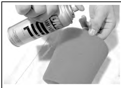
TYPISCH - FILTER MET OLIE SMEREN
