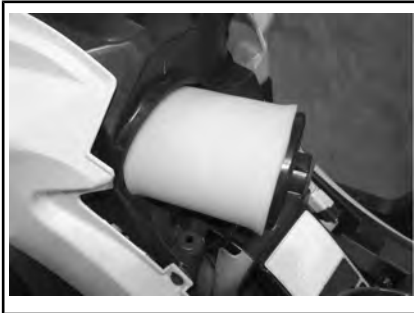
VERWIJDEREN VAN DE LUCHTFILTER
