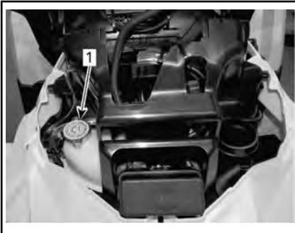
1. Tappo del serbatoio liquido refrigerante motore
