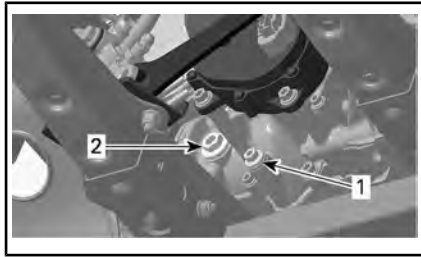
1. Bouchon magnétique de vidange 2. Bouchon de niveau d'huile
