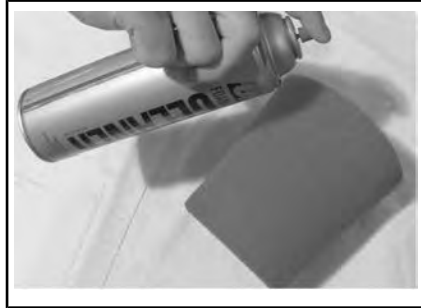
TÍPICO - ROCÍE EL FILTRO DE ESPUMA.
