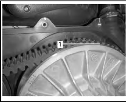
1. Parte inferior de los dientes a la altura de la superficie externa de la correa conductora
