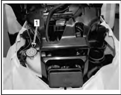
1. Depósito de refrigerante del motor
