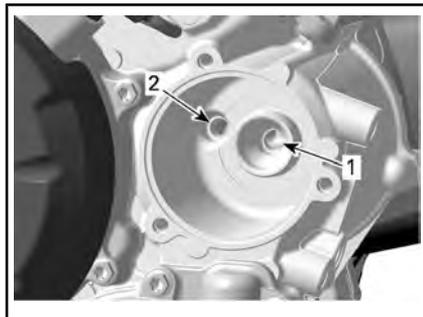
1. Einlass-Bohrung der Ölpumpe zum Ölfilter
