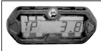
Sie kann verwendet werden, um beispielsweise die Reichweite einer Tankfüllung oder die Entfernung zwischen zwei bestimmten Punkten zu bestimmen.
