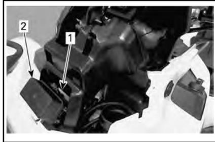
1. Vorderer Sicherungskasten
