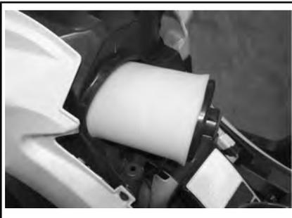
**AUSBAU DES LUFTFILTERS****Entleeren und Inspektion des Motorluftfilterkastens**
