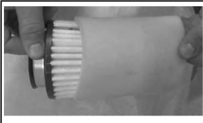
**TYPISCH****Einbau des Luftfilters**
