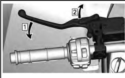
Schritt 1: Betätigen Sie die Bremsen
