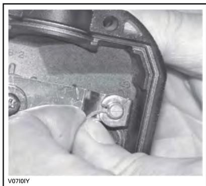
Снимите боковую крышку корпуса дроссельной заслонки.
