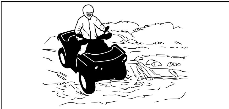
Попадание воды на тормозные механизмы оказывает неблагоприятное влияние на эффективность тормозной системы. После преодоления водной преграды, движения по грязи или снегу просушите тормозные колодки, несколько раз приведя тормоза в действие. Оставляйте больше места для торможения.
