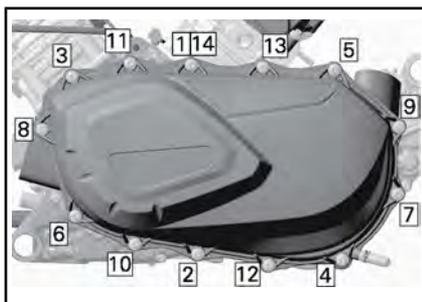
ПОРЯДОК ЗАТЯЖКИ ВИНТОВ КРЫШКИ ВАРИАТОРА
