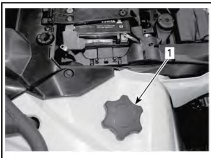
1. Пробка топливного бака
