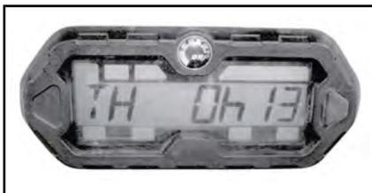
Для сброса показаний счетчика моточасов нажмите и удерживайте в течение 2 секунд кнопку выбора режима индикации.
