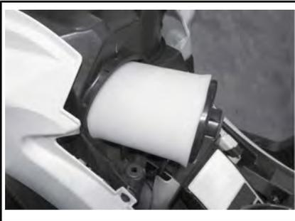
**СНЯТИЕ ВОЗДУШНОГО ФИЛЬТРА**
