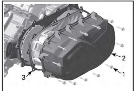
1. Винт крышки вариатора
