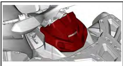
Снимите крышку расширительного бачка.
