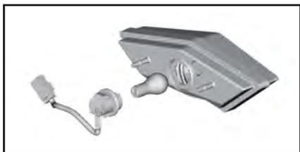
3. Отсоединить электрический разъем лампы от заднего фонаря.
