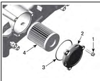
1. Винт крепления крышки масляного фильтра
