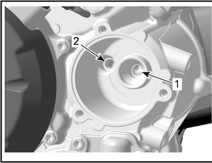
1. Впускное отверстие (из масляного насоса в масляный фильтр)
