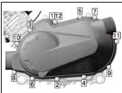
ПОСЛЕДОВАТЕЛЬНОСТЬ ЗАТЯЖКИ ВИНТОВ КРЕПЛЕНИЯ КРЫШКИ ВАРИАТОРА
