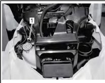
1. Крышка расширительного бачка системы охлаждения двигателя
