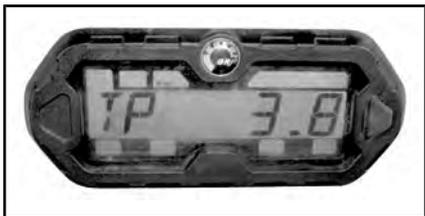
Pressione e **SEGURE** o botão seletor por 2 segundos para zerar o odômetro parcial.
