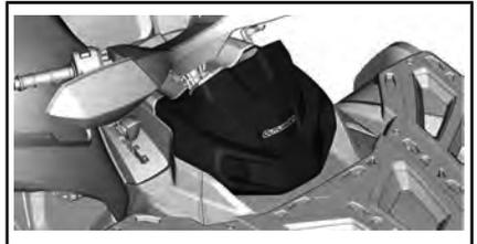
Remova a tampa do reservatório de líquido de arrefecimento do motor.
