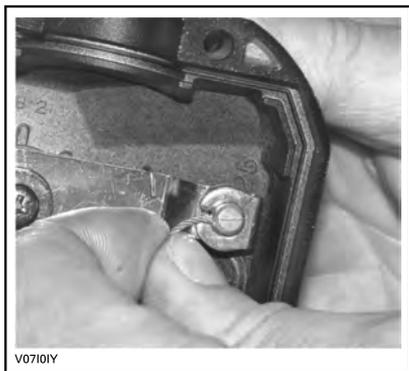
Remova a proteção lateral do corpo do acelerador.
