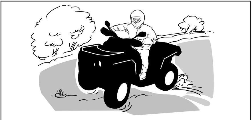
Se você deslizar ou derrapar, virar o guidão na direção do movimento pode ajudar a recuperar o controle do veículo. Nunca freie com força e trave as rodas.
