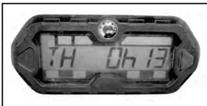
Pressione e **SEGURE** o botão seletor por 2 segundos para zerar o contador de horas de viagem.
