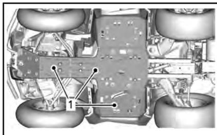
1. Placa de proteção em toda a parte inferior do veículo
