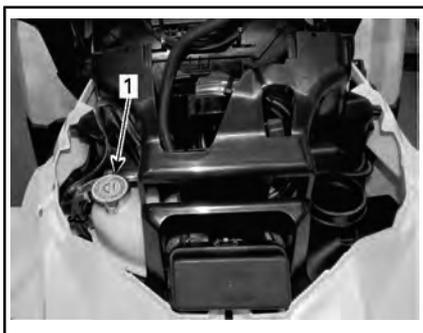
1. Reservatório do líquido de arrefecimento do motor
