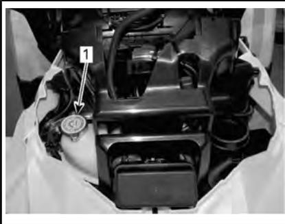
1. Tappo del serbatoio liquido refrigerante motore
