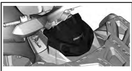
Rimuovere il tappo del serbatoio del liquido refrigerante motore.
