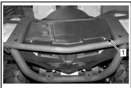
1. Dispositivo di chiusura del vano bagagli posteriore
