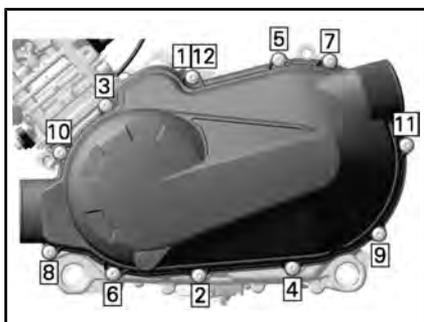
SEQUENZA DI SERRAGGIO DELLA CARENATURA DELLA CVT
