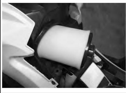
*RIMOZIONE DEL FILTRO DELL'ARIA*
