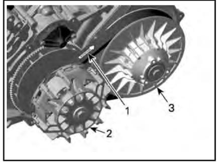
1. Flecha orientada hacia la parte trasera del vehículo
