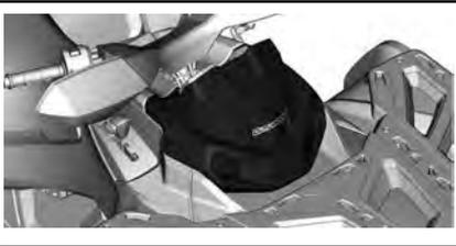
Quite el tapón del depósito del refrigerante del motor.
