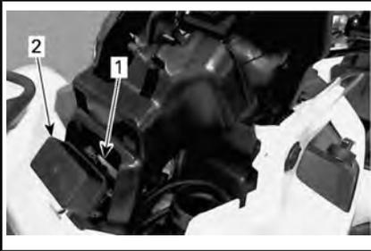
1. Vorderer Sicherungskasten
