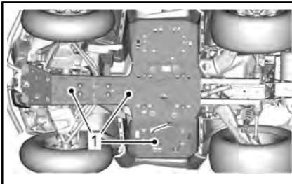
1. Komplette Unterboden-Schutzplatte
