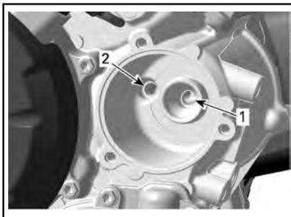
1. Einlass-Bohrung der Ölpumpe zum Ölfilter
