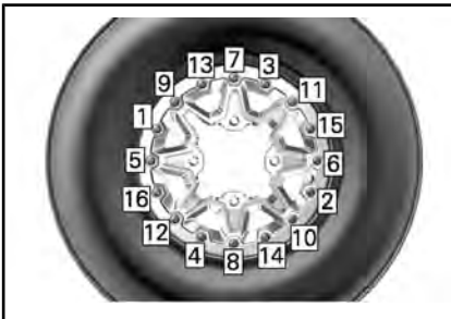
ТИПОВОЙ ВАРИАНТ - ПОРЯДОК ЗАТЯЖКИ ВИНТОВ
