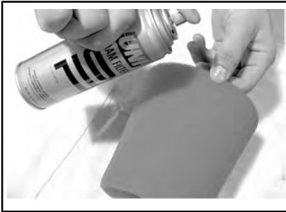
ТИПОВОЙ ВАРИАНТ - НАНЕСЕНИЕ МАСЛА НА ПОРОЛОНОВЫЙ ФИЛЬТР
