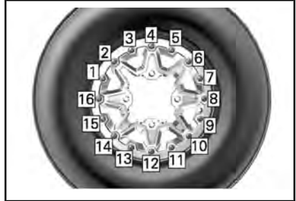
ТИПОВОЙ ВАРИАНТ - ЗАКЛЮЧИТЕЛЬНЫЙ ЭТАП ЗАТЯЖКИ ВИНТОВ
