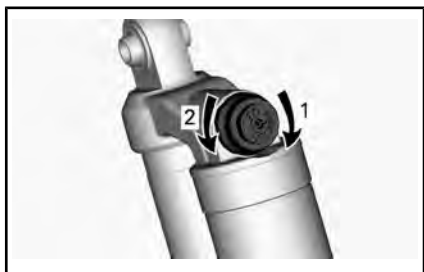
КОМПРЕССИОННОЕ ДЕМПФИРОВАНИЕ СЖАТИЯ — ВЕРХНЯЯ ЧАСТЬ АМОРТИЗАТОРА
