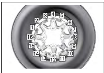
代表例 - 最後の締め付け順序
