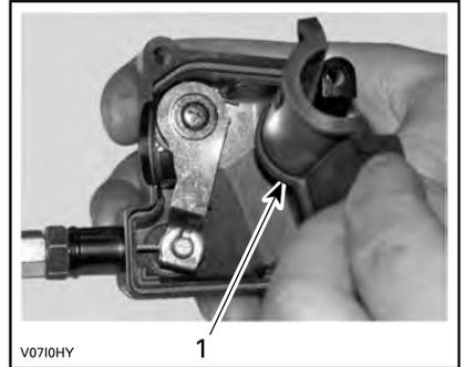
1. Protezione interna dell'alloggiamento
