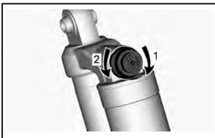
**SMORZAMENTO IN COMPRESIONE - PARTE SUPERIORE DELL'AMMORTIZZATORE**
