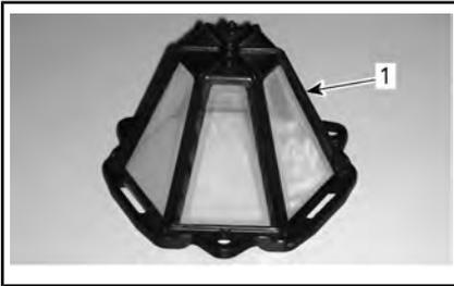
1. Filtro dell'aria CVT (tipo clip-on)
