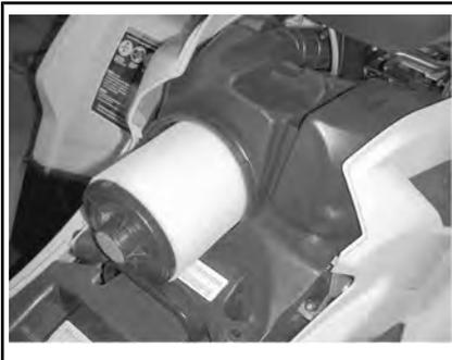
*RIMOZIONE DEL FILTRO DELL'ARIA*
