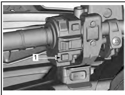
1. Pulsante *Override* (controllo manuale del motore)/modalità DPS (servosterzo dinamico)
