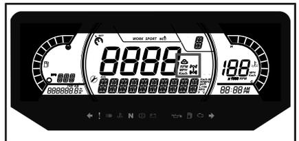
L'affichage au milieu à droite indique le mode de fonctionnement sélectionné :
