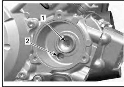
1. Orificio de salida al sistema de suministro de aceite al motor
