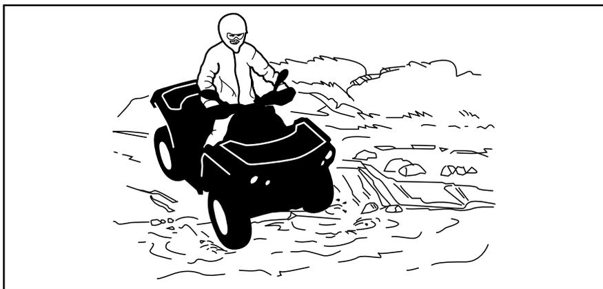
Si los frenos están húmedos, la capacidad de frenado del vehículo se ve afectada. Asegúrese de que se sequen los frenos; para ello, accíonelos varias veces después de salir del agua, del barro o de la nieve con el vehículo. Tenga en cuenta la necesidad de una mayor distancia para el frenado.
