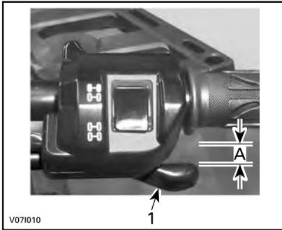
1. Palanca del acelerador
