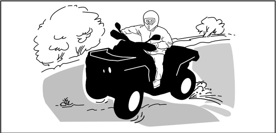
Si el vehículo derrapa o resbala, puede resultar de utilidad girar el manillar en la dirección del deslizamiento hasta que vuelva a recuperar el control. Procure que no se bloqueen nunca los frenos ni las ruedas.
