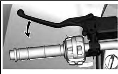
Die Bremswirkung ist proportional zur Kraft, die auf den Hebel ausgeübt wird.
