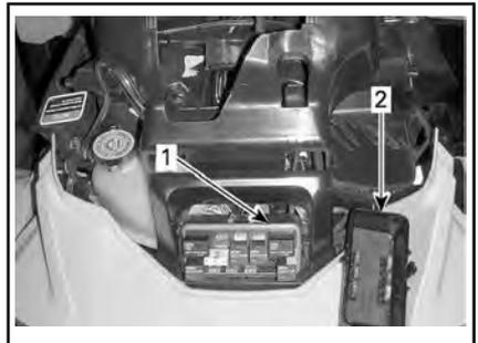
1. Vorderer Sicherungskasten
