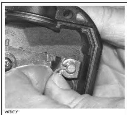
Entfernen Sie die Seitenabdeckung der Drosselklappe.
