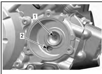
1. Auslass-Bohrung zur Ölspeisung des Motors
