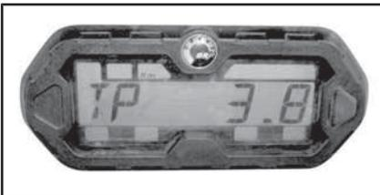
Il peut également servir à calculer l'autonomie du véhicule tout-terrain ou la distance entre deux points.
