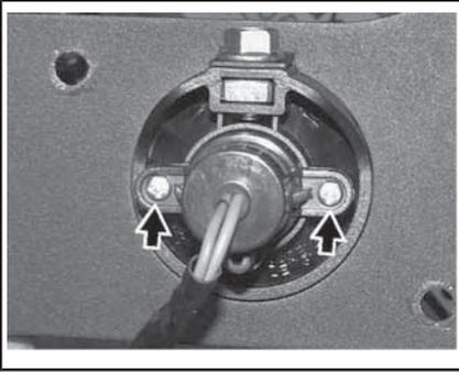
**DÉVISSER LES VIS DE SÉCURITÉ DE L'AMPOULE DU CLIGNOTANT AVANT**
