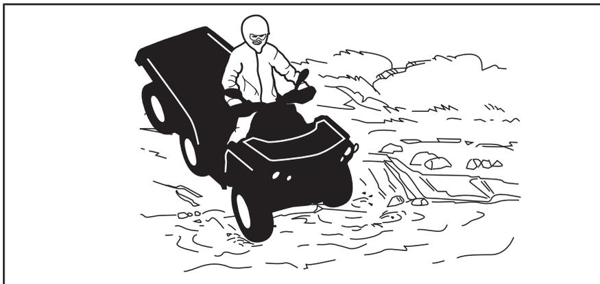
Des freins mouillés réduisent la capacité de freinage. Après être sorti de l'eau, de la neige ou de la boue, actionnez les freins plusieurs fois pour que la chaleur de la friction sèche les freins. Prévoir davantage de distance pour freiner.
