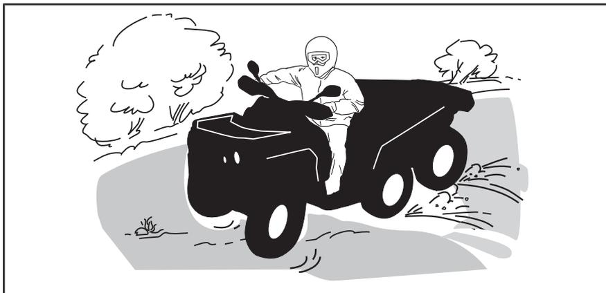
Si le véhicule se met à glisser, tournez le guidon dans la direction du glissement jusqu'à la reprise de la maîtrise du véhicule. Ne serrez jamais les freins à fond et ne bloquez jamais les roues.
