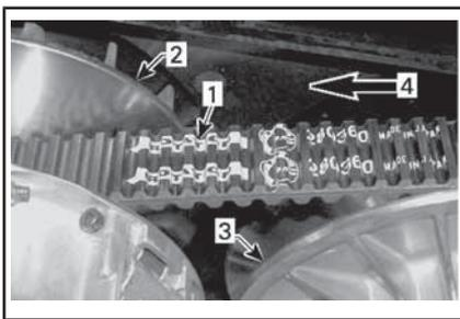
1. Flèche imprimée sur la courroie
