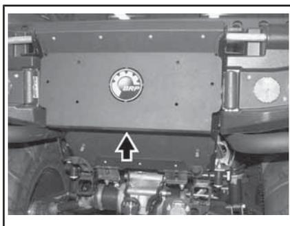
Para abrir la cubierta del compartimento de almacenamiento
