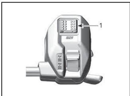
Seleccione entre los modos NORMAL, SPORT y WORK empujando el selector en la parte izquierda o derecha.
