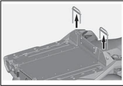
3. Coloque la pared lateral sobre la plataforma y bájela hasta su posición.
