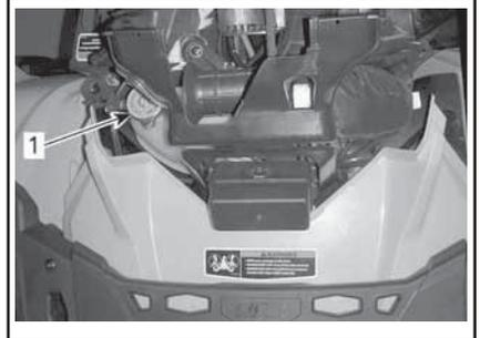
1. Tapón del depósito de refrigerante del motor
