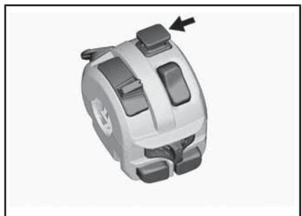
Pulse el botón hacia abajo para encender las luces de emergencia. Tire de él hacia arriba para apagarlas.
