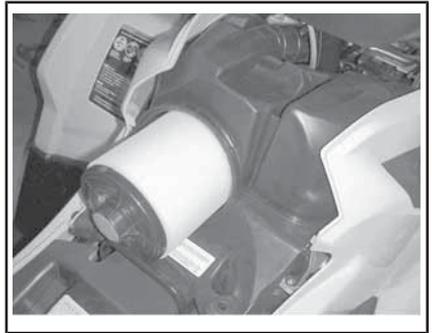
**AUSBAU DES LUFTFILTERS****Entleeren und Inspektion des Motorluftfilterkastens**
