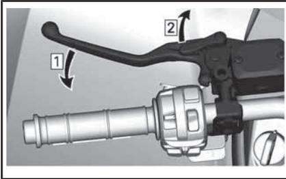
Schritt 1: Betätigen Sie die Bremsen
