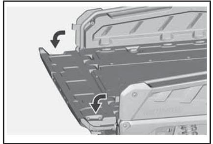
3. Setzen Sie die Stützhalterungen an der Heckklappe an.
