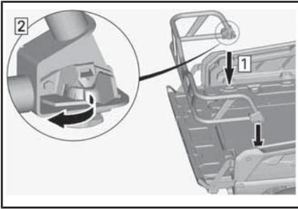
5. Installieren Sie die Heckklappenlastverlängerung.
