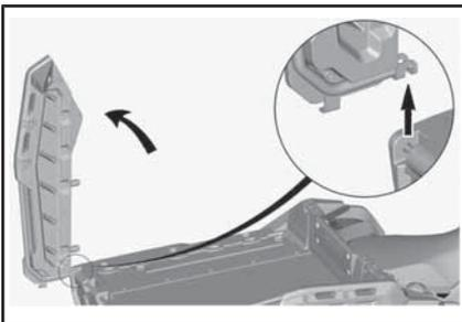
6. Entfernen Sie die Ladeklappe.
