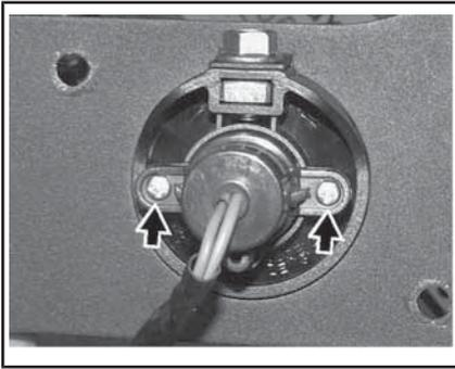
**BEFESTIGUNGSSCHRAUBEN VON DER GLÜHLAMPE DES RÜCKWÄRTIGEN FAHRRICHTUNGSANZEIGERS ABSCHRAUBEN**
