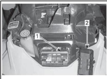
1. Vorderer Sicherungskasten
