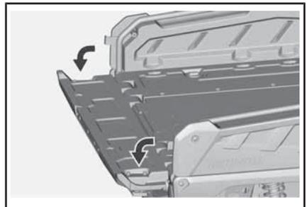
3. Entfernen Sie die Federstecker der Verriegelungsgriffe an beiden Seiten.
