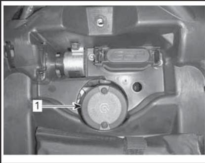
1. Behälter für Bremsflüssigkeit der hinteren Bremse
