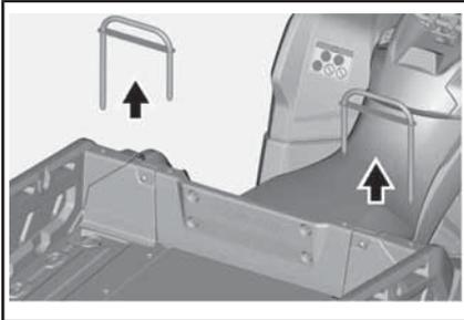
5. Heben Sie die Seitenwand hoch und entfernen Sie sie. Wiederholen Sie den Vorgang auf der anderen Seite.
