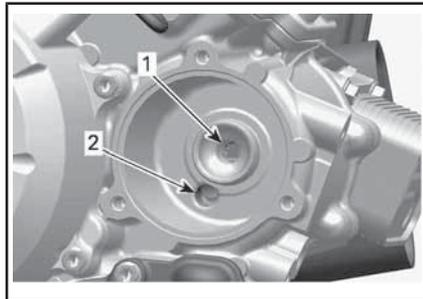
1. Auslass-Bohrung zur Ölspesung des Motors
