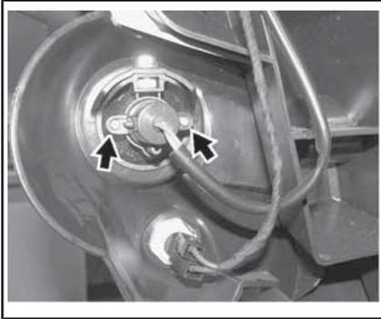
BEFESTIGUNGSSCHRAUBEN VON DER GLÜHLAMPE DES VORDEREN FAHRRICHTUNGSANZEIGERS ABSCHRAUBEN
