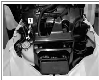
1. Behållare för motorkylvätska
