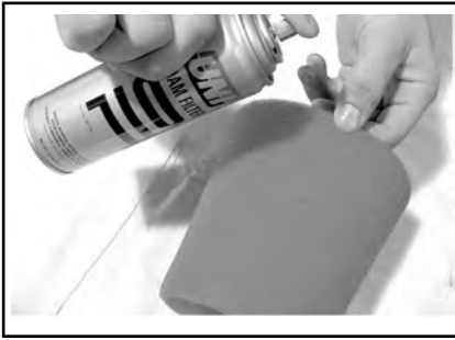
ТИПОВОЙ ВАРИАНТ - НАНЕСЕНИЕ МАСЛА НА ПОРОЛОНОВЫЙ ФИЛЬТР
