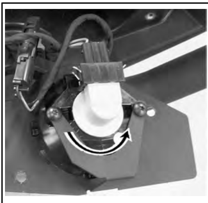
ТИПОВОЙ ВАРИАНТ: ПОВЕРНИТЕ ЛАМПУ ПРОТИВ ЧАСОВОЙ СТРЕЛКИ
