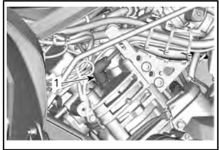
ЛЕВАЯ СТОРОНА – ПЕРЕДНИЙ ЦИЛИНДР 1. Свеча зажигания
