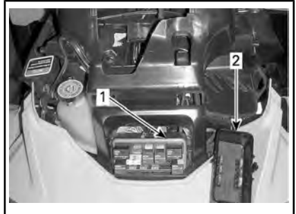
1. Передний блок предохранителей 2. Крышка переднего блока предохранителей
