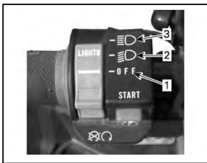
ФУНКЦИИ ПЕРЕКЛЮЧАТЕЛЯ СВЕТА ФАР
