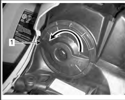
1. Крышка воздушного фильтра
