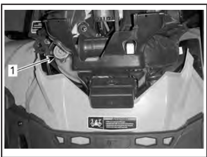
1. Расширительный бачок системы охлаждения двигателя
