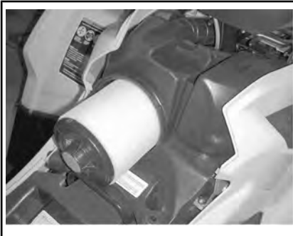
СНЯТИЕ ВОЗДУШНОГО ФИЛЬТРА
