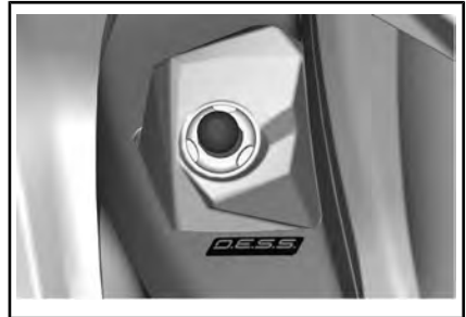
DESS КОНТАКТНОЕ УСТРОЙСТВО
