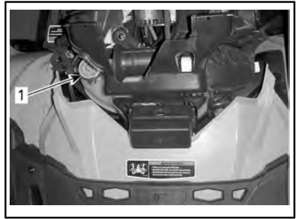
1. Крышка расширительного бачка системы охлаждения двигателя
