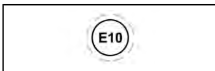
UBICAZIONE: ACCANTO AL TAPPO DEL SERBATOIO
