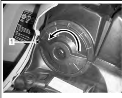
1. Copertura filtro dell'aria
