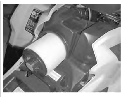
RIMOZIONE DEL FILTRO DELL'ARIA
