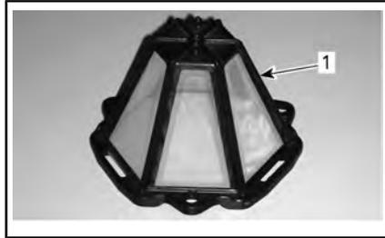
1. Filtro de aire de la CVT (tipo acoplable)
