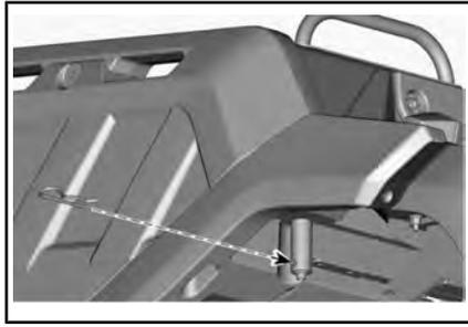
6. Installieren Sie die Heckklappe.
