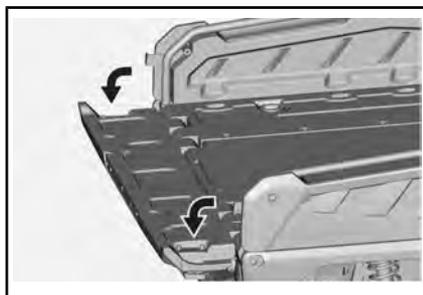
3. Entfernen Sie an beiden Seiten die Federstecker der Verriegelungsgriffe.
