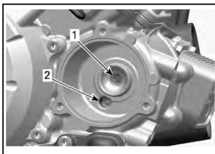
1. Auslass-Bohrung zur Ölspeisung des Motors
