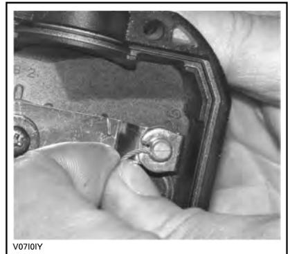
Entfernen Sie die Seitenabdeckung der Drosselklappe.
