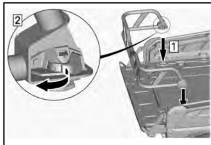
5. Installieren Sie die Heckklappenverlängerung.
