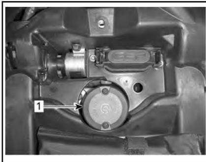
1. Behälter für Bremsflüssigkeit der hinteren Bremse
