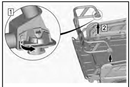
3. Entfernen Sie die Stützhalterungen von der Heckklappe.
