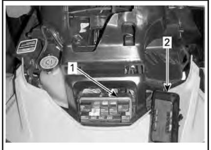
1. Vorderer Sicherungskasten
