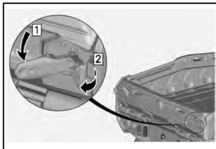
2. Klappen Sie die Heckklappe herunter.
