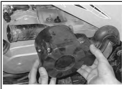
СНЯТИЕ КОРПУСА ВОЗДУШНОГО
