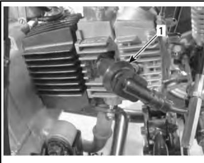
1. Провод свечи зажигания
