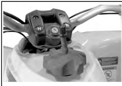
ТИПОВОЙ ВАРИАНТ — КРЫШКА ТОПЛИВНОГО БАКА
