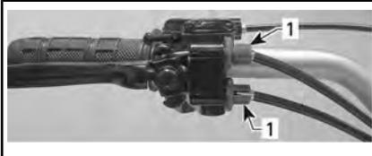
1. Регулировочные винты на рычаге тормоза
