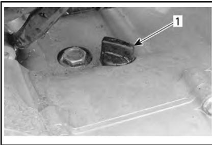
*ПРОБКА ЗАЛИВНОГО ОТВЕРСТИЯ —
