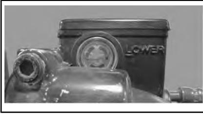
*ЛЕВЫЙ ЗАДНИЙ БАЧОК ДЛЯ ТОРМОЗНОЙ ЖИДКОСТИ*
