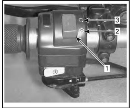
1. Interrupteur d'arrêt d'urgence du moteur
