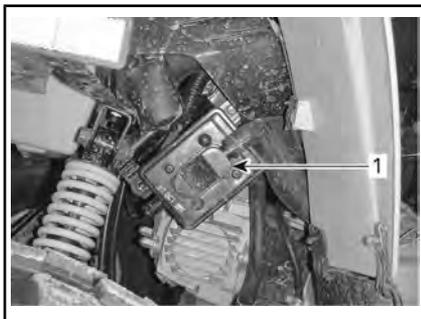
1. Soupape d'injection d'air
