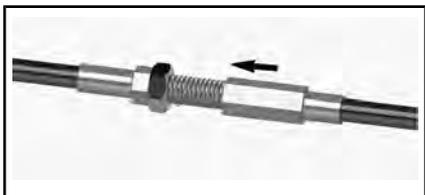
**RAMENER L'ÉCROU DE RÉGLAGE D'UN TOUR**
