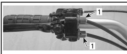
1. Tornillos de ajuste en la palanca
