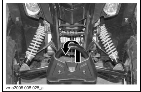
DS 70 AND DS 90 — FRONT TIE-DOWN POINT LOCATION
