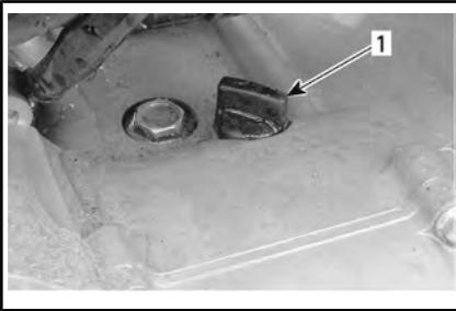
**EINFÜLLSCHRAUBE — LINKE MOTORSEITE**
