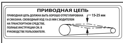
НАКЛЕЙКА ДЛЯ РЕГУЛИРОВКИ ПРИВОДНОЙ ЦЕПИ
