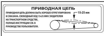
*НАКЛЕЙКА ДЛЯ РЕГУЛИРОВКИ ПРИВОДНОЙ ЦЕПИ*
