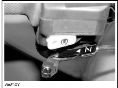
*CHOKE LEVER IN THE FULL CHOKE POSITION*
