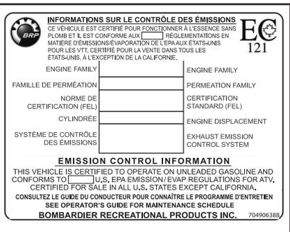
**TYPIQUE : APPLICABLE LORSQU'ÉQUIVALENT À UN MODÈLE CERTIFIÉ AUX NORMES DE L'EPA - EMPLACEMENT : SOUS LE SIÈGE, SUR LE LONGERON SUPÉRIEUR DU CHÂSSIS**
