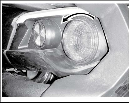
Débranchez le connecteur de l'ampoule.
