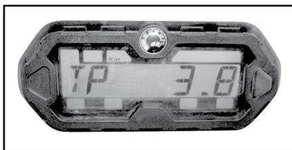
Può essere usato per stabilire la resa di un pieno di carburante, oppure per misurare la distanza di due diversi percorsi.
