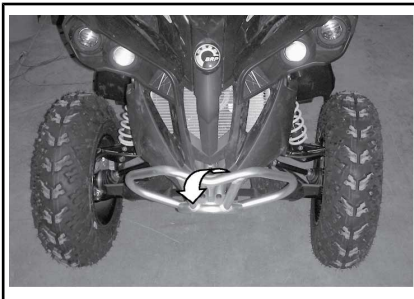
TÍPICO - LOCALIZAÇÃO DO PONTO DE SUJEIÇÃO DIANTEIRO
