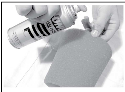
TÍPICO - LUBRIFIQUE O FILTRO DE ESPUMA
