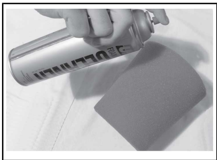
TYPISCH - SPUIT HET OP DE SCHUIMFILTER
