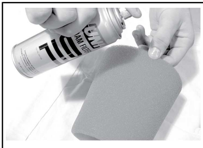
TYPISCH - FILTER MET OLIE SMEREN
