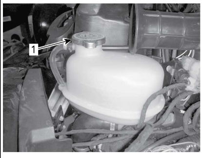
1. Tapón del depósito de refrigerante del motor
