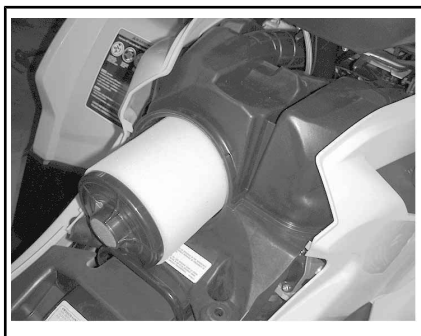
1. Tampa do filtro de ar Remova o filtro de ar.
