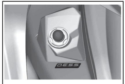
ANCLAJE D.E.S.S. DEL MOTOR
