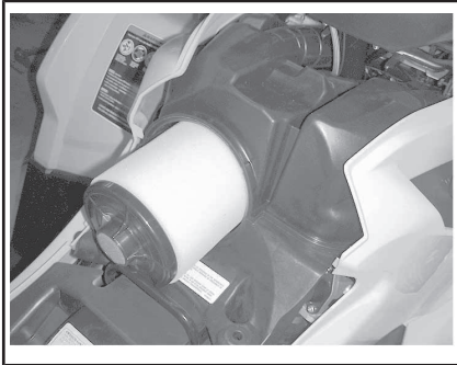
EXTRACCIÓN DEL FILTRO DE AIRE
