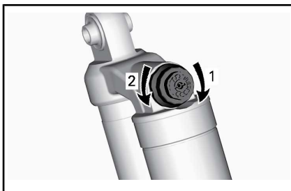
KOMPRESSONSDÄMPNING - ÖVERST PÅ STÖTDÄMPAREN
