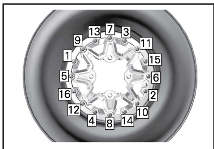
SITUAZIONE TIPICA - SEQUENZA DI SERRAGGIO
