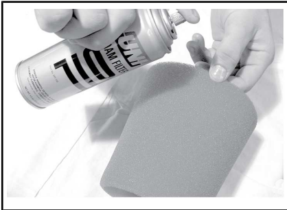
TYPISCH - SCHAUMSTOFFFILTER ÖLEN
