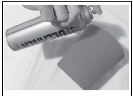
TYPISCH - SCHAUMSTOFFFILTER BESPRÜHEN
