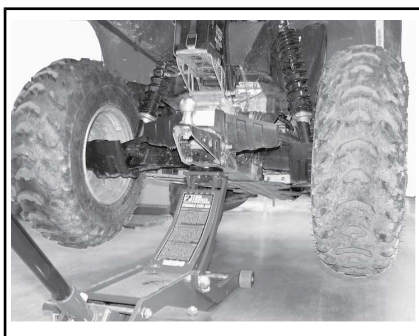
CONFIGURAZIONE TIPICA - PUNTO DI SOLLEVAMENTO POSTERIORE
