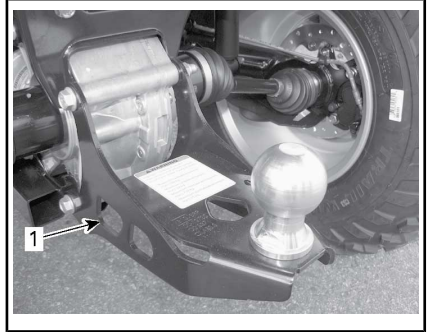
TYYPILLINEN – KIINNITYSKOHTA TAKANA
