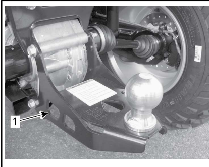
TYYPILLINEN – KIINNITYSKOHTA TAKANA
