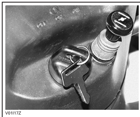
LEVIER D'ÉTRANGLEUR EN POSITION «OFF»
