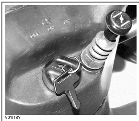
LEVIER D'ÉTRANGLEUR EN POSITION «FULL CHOKE»
